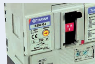
Termiskt skydd är justerbart från 63% till 100% av märkström
